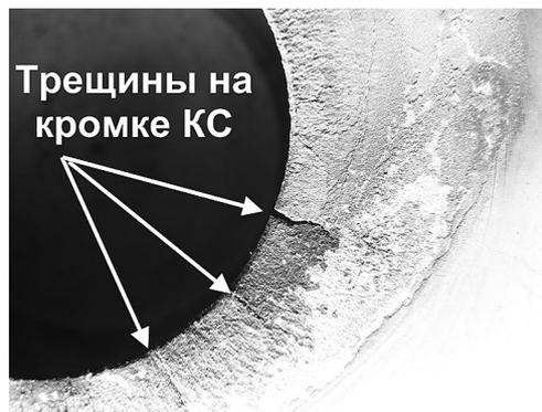
Рис. 2. Расположение трещин в кромке КС поршня тракторного дизеля
