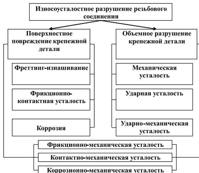
Рис. 3. Классификация факторов износоусталостного разрушения соединений деталей рабочих органов с.-х. машин и орудий
