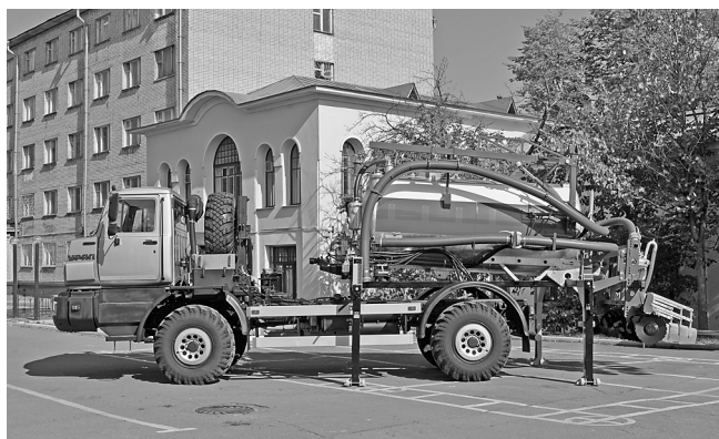
Рис. 1. ТТА со сменной технологической надстройкой СТА-5ЖО на базе автомобильного шасси Урал-432065
