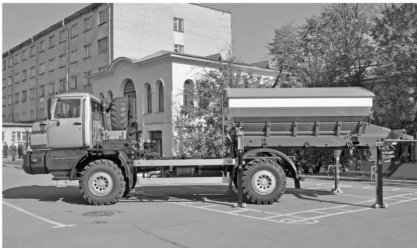
Рис. 1. ТТА со сменной технологической надстройкой СТА-5ТМ на базе автомобильного шасси Урал-432065
