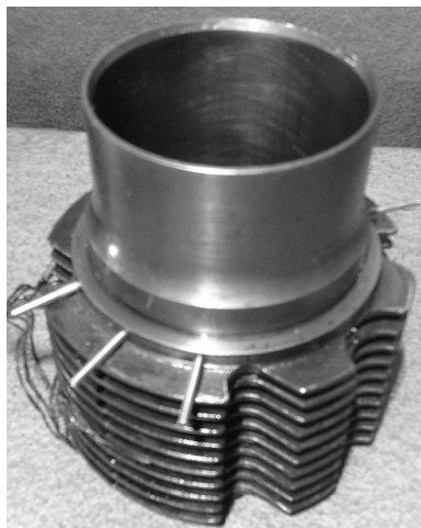
Рис. 2. Общий вид опытного цилиндра, снабженного маслосборными тонкостенными трубками
