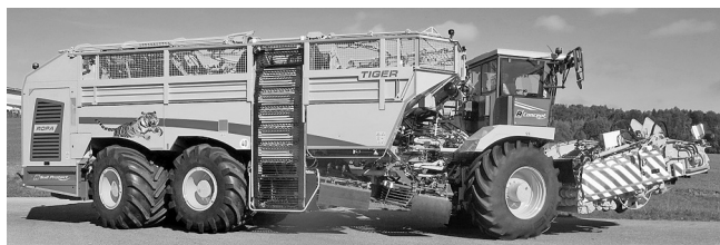
Рис. 1. Самоходный свеклоуборочный комбайн Rora Tiger 6
