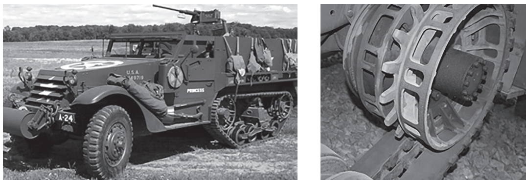
Рис. 1. Комбинированное цевочно-фрикционное зацепление ВК с образцом РАГ с подпором беговых дорожек гусениц ступичными барабанными конструкциями, установленное на полугусеничном БТР серии М2-М9 производства США
