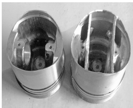
Рис. 6. Серийный (слева) и опытный (справа) поршни для дизеля 1Ч 85/80
