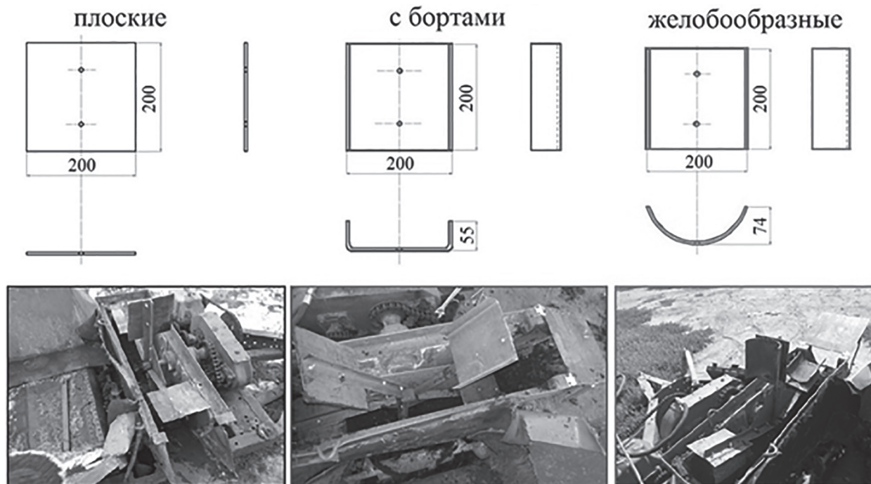
Рис. 3. Экспериментальные образцы лопаток рабочего органа
