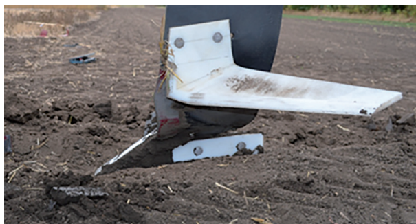
Рис. 4. Самоочищение элементов из пластика рабочего органа
