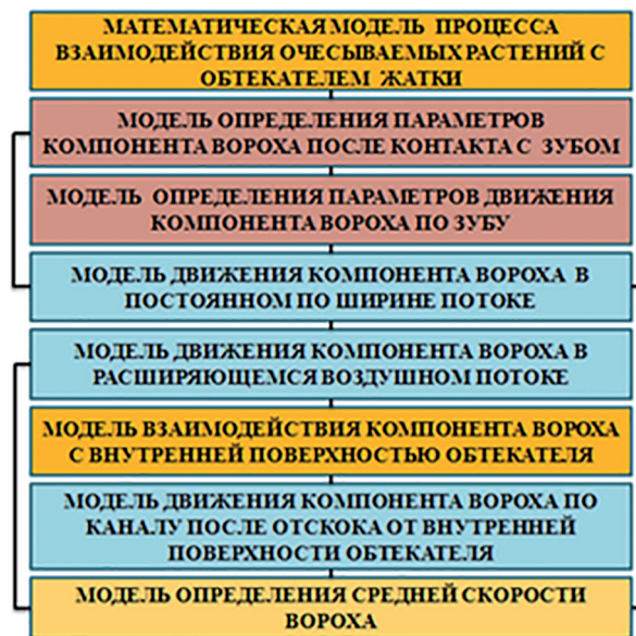
Рис. 2. Логическая схема математической модели процесса очеса зерновых культур однобарабанной жаткой
