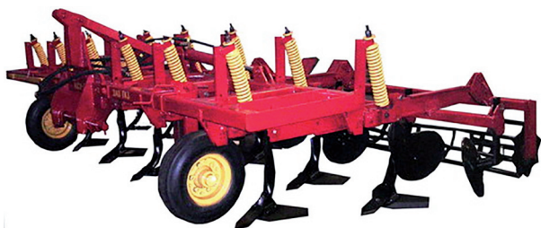
Рис. 1. Серийный стерневой культиватор КСУ-6 совместного российско-германского производства
