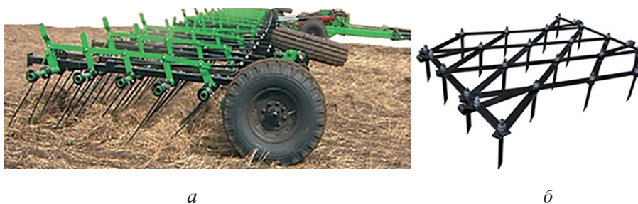
Рис. 2. Зубовые бороны: a – широкозахватная борона БТ-18 с пружинными зубьями; б – модульная борона БЗСС-1,0 с жесткими зубьями квадратного сечения
