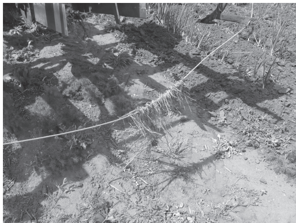
Рис. 3. Крепление гибкого элемента в виде троса на экспериментальной рыхлительно-сепарирующей почвообрабатывающей установке
