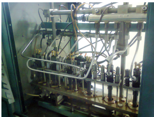
Рис. 1. Общий вид топливной аппаратуры, установленной на стенде. На переднем плане – длинные опытные топливопровода высокого давления
