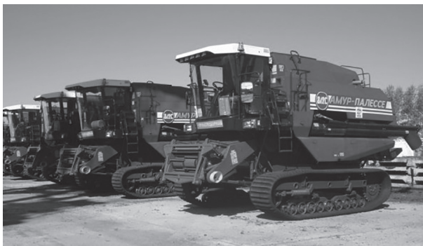
Рис. 4. Комбайн зерноуборочный с резиноармированной гусеницей КЗС-812С «Амур-Палессе»
