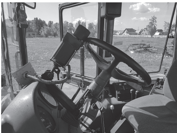
Рис. 2. Крепление управляющего электродвигателя к рулевому колесу
