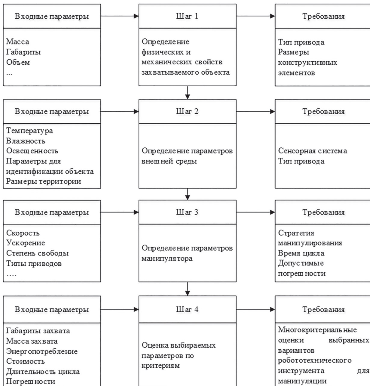
Рис. 1. Методика проектирования захвата для манипуляций сельскохозяйственной продукцией
