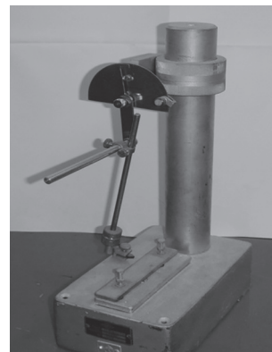
Рис. 3. Установка для проведения испытаний по определению динамической микротвердости
