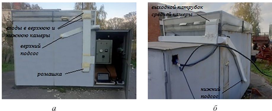
Рис. 2. Общий вид сушилки с комбинированным теплообменником: а – со стороны верхнего подсоса; б – со стороны нижнего подсоса
