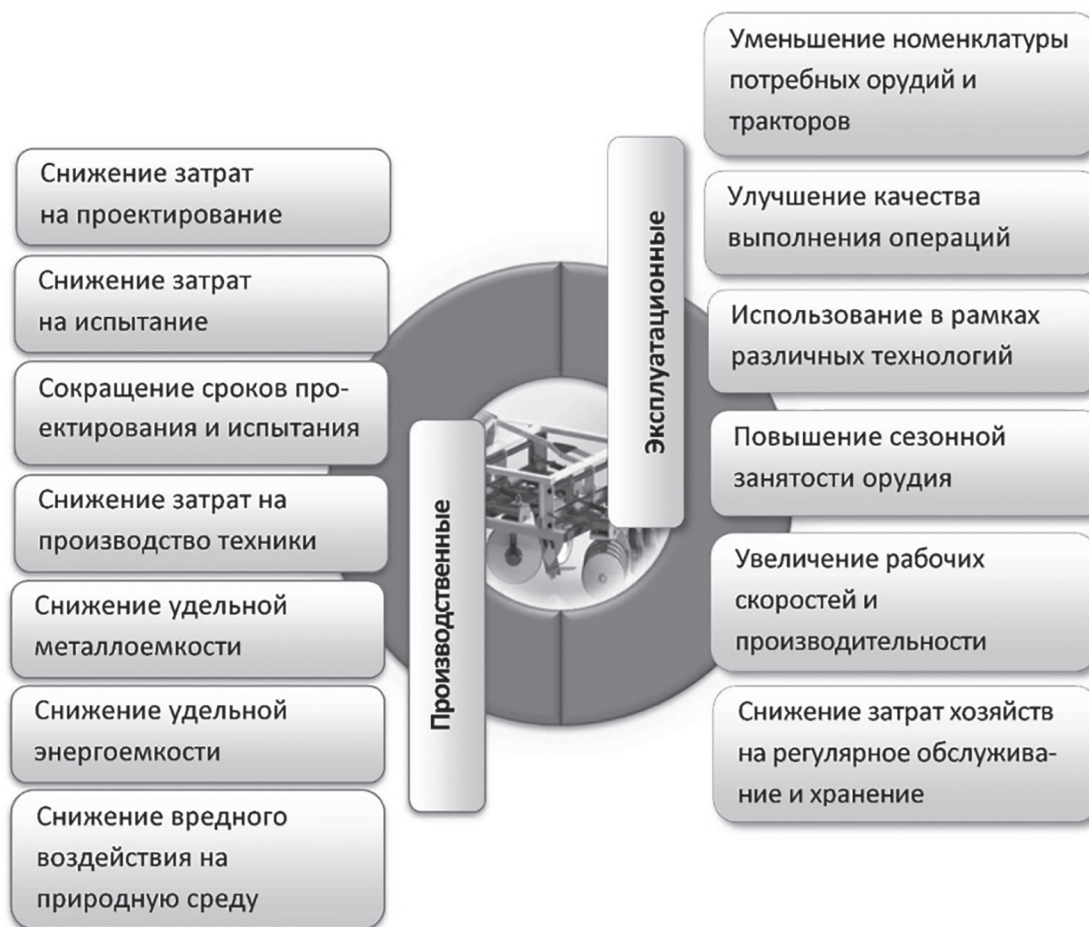
Рис. 2. Факторы, обеспечивающие эффективность внедрения блочно-модульной концепции построения лесохозяйственных орудий
