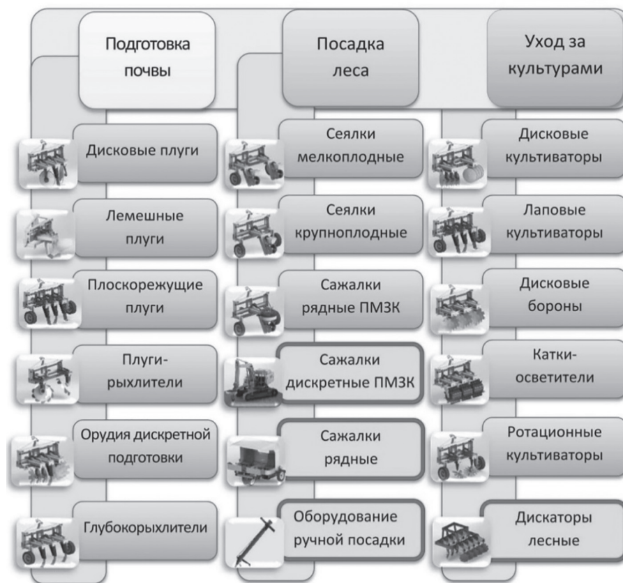
Рис. 7. Почвообрабатывающие и посадочные орудия, применяемые при лесовосстановлении на вырубках
