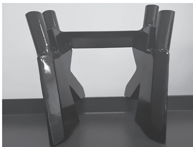
Рис. 3. Сошник для разноуровневого высева семян и минеральных удобрений: а – схема; б – опытный образец; 1 – рабочий элемент; 2 – стойка; 3 – туконаправитель; 4 – семянаправитель; 5 – кронштейн; 6, 7 – вырез
