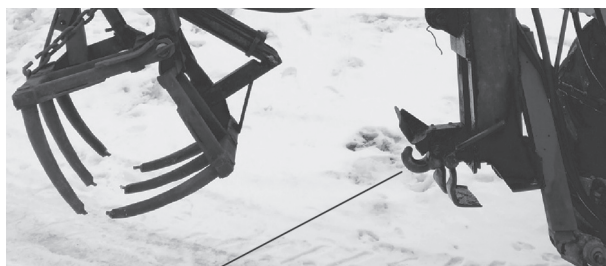
Рис. 11. Сцепное устройство: 1 – серьга
