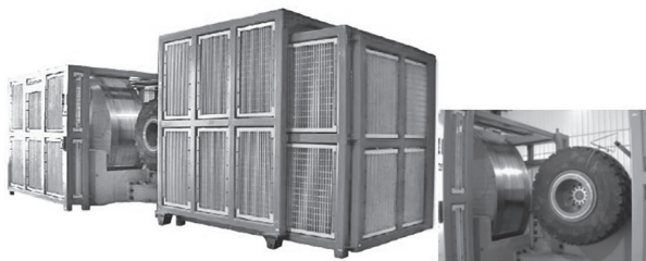
Рис. 1. Стенд TJR-1-OTR (Y) для испытания радиальной прочности шин (однопозиционный)
