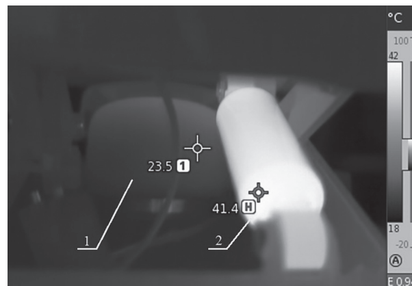
Рис. 8, б. Термограмма подвески сиденья в действии на 30-й минуте испытаний: 1 – пневматическая рессора; 2 – амортизатор
