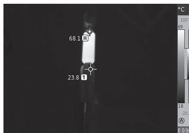
Рис. 3, б. Термограмма амортизатора в действии на 3-й минуте испытаний
