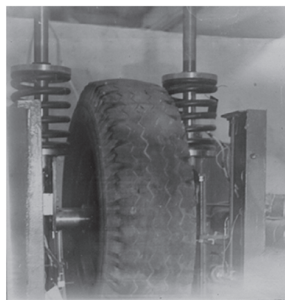
Рис. 2. Вид колеса автомобиля УАЗ-450Д на стенде для испытаний подвесок и шин кафедры «Автоматические установки» ВолгГТУ
