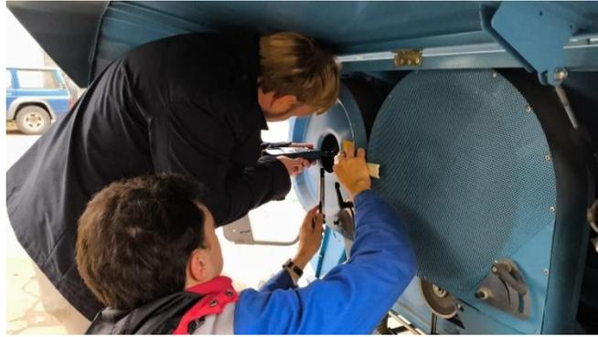
**Рис. 13.** Измерение частоты вращения вала вентилятора и скорости воздушного потока.
