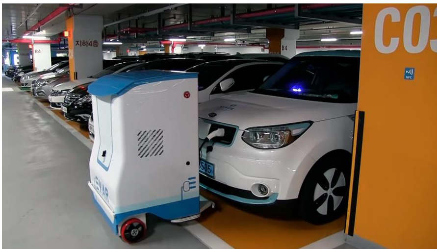
Рис. 11. Роботизированная мобильная зарядная станция EVAR от «Samsung». Заимствовано из: https://cdn.hevcars.com.ua/wp-content/uploads/2018/09/samsung-ev-ar-hevcars-1.jpg . (Правообладатель неизвестен, web-сайт недоступен)
