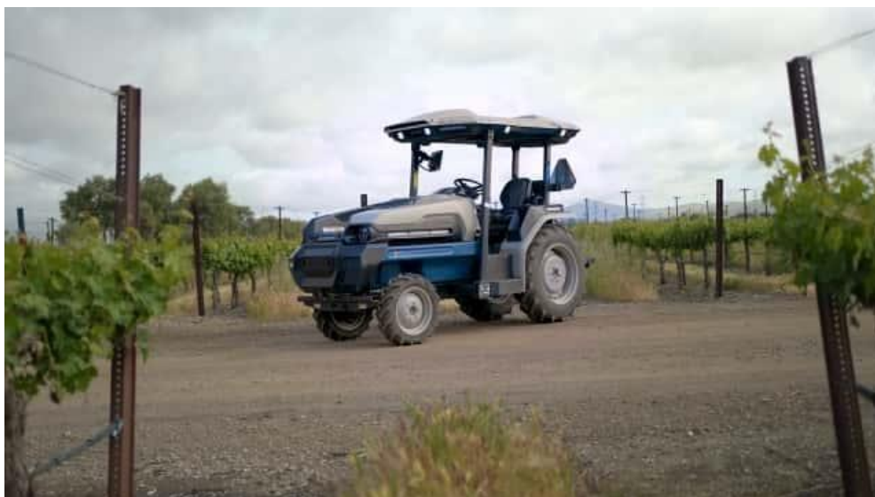
Рис. 2. Трактор с тяговым электроприводом Monarch МК-V. Заимствовано из: https://www.monarchtractor.com/hs-fs/hubfs/mkv-base%2Bballasts.png?width=400&name=mkv-base%2Bballasts.png . © Zimeno Inc. dba Monarch Tractor, 2022. Все права защищены
