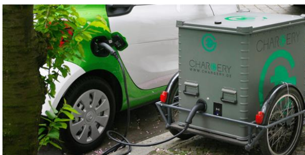
Рис. 7. Мобильная электрозарядная станция на базе велотрайка. Заимствовано из: https://a.d-cd.net/iP42d1BzyQy21DnIs6HcrMyq7ug-1920.jpg . Доступ к информации о правообладателе заблокирован или сайт не работает). 2019.
