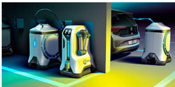
Рис.12. Концепция роботизированного зарядного комплекса от «Volkswagen Group». Заимствовано из: https://i.bstr.es/highmotor/2019/12/volkswagen-robot-carga-1-880x440.jpg . © Volkswagen. 2019. Все права зарегистрированы.
