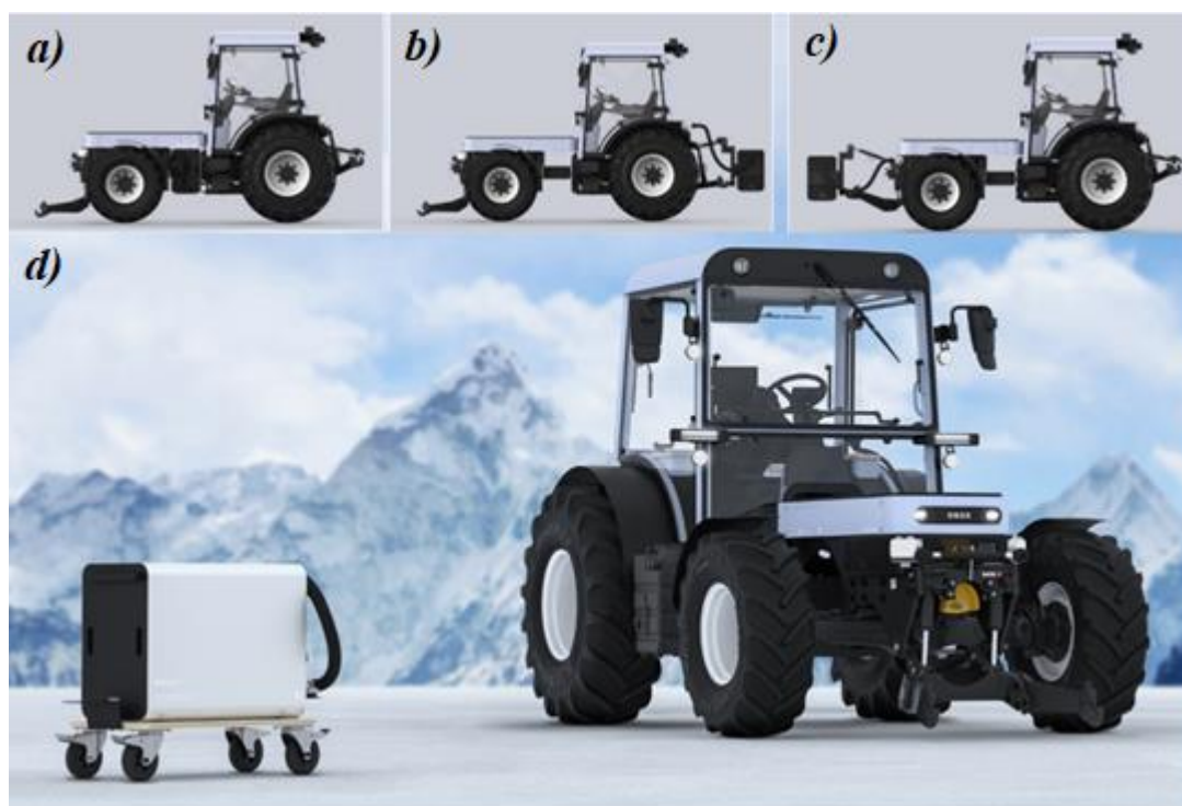
Рис. 3. Трактор с тяговым электроприводом ONOX 1 и схема использования сменных аккумуляторных батарей. А — с аккумуляторной батареей в базе; b — с аккумуляторной батареей на подвесе сзади; c — с аккумуляторной батареей на подвесе спереди; d — общий вид электротрактора и съемного аккумуляторного блока. Изображение адаптировано с изменениями из: https://framerusercontent.com/images/pTX5xB7qNTgmypHND9Besvn1zs.jpg?scale-down-to=2048 . © ONOX, 2025. Все права защищены.
