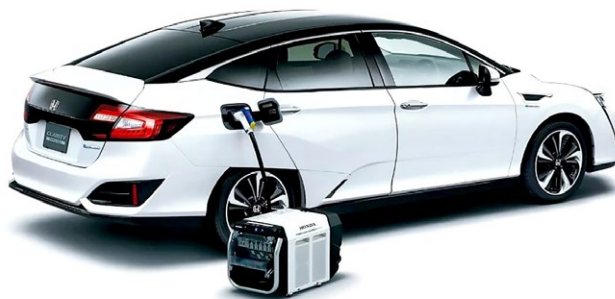
Рис. 9. Honda Clarity Fuel Cell и модуль Power Exporter 9000. Заимствовано из: https://www.log.com.tr/wp-content/uploads/2017/02/clarity-660x371.jpg . © Honda Motor Co., Ltd. и ее дочерние и зависимые компании. 2014. Все права защищены.
