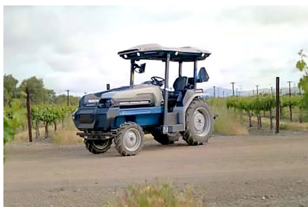
Рис. 2. Трактор с тяговым электроприводом Monarch MK-V. Заимствовано из: https://www.monarchtractor.com/hs-fs/hubfs/mkv-base%2Bballasts.png?width=400&name=mkv-base%2Bballasts.png . © Zimeno Inc. dba Monarch Tractor, 2022. Все права защищены.
