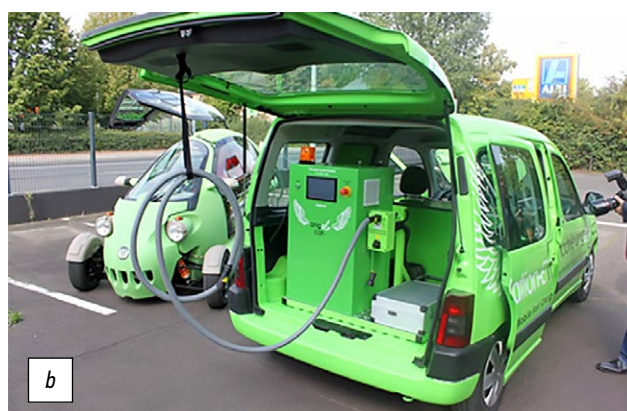
Рис. 5. Мобильные электростанции на базе малотоннажных фургонов: a — на базе фургона N1, b — на базе фургона M1. Заимствовано из https://images.forococheselectricos.com/image/l/1100w/wp-content/uploads/2014/05/Tim-Hartles-demonstrates-the-RACs-new-electric-charger-2-800x579.jpg © ZERauto.nl, 2014. Все права защищены. и http://https://www.pinterest.com/pin/angel-car-worlds-first-mobile-charging-station-for-electric-cars--431923420493496566 .
