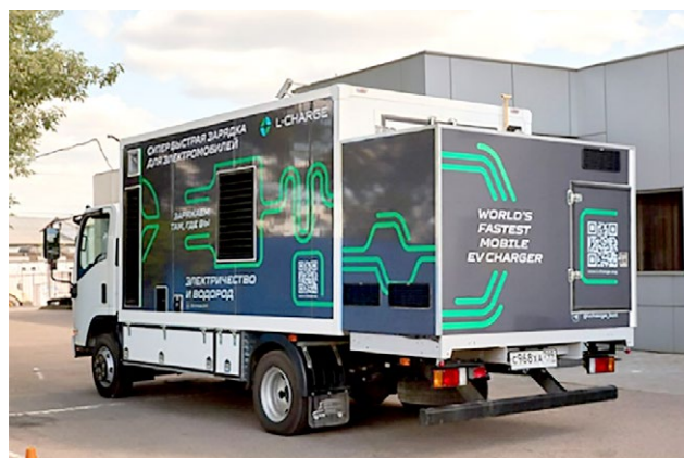
Рис. 4. Мобильная электростанция на базе грузового шасси. Заимствовано из: https://cdn.matador.tech/source//2/E2yoauidp4Wp4x5zWA17-vSAIOVpudiE.jpeg © портал Matador. 2021. Все права защищены.
