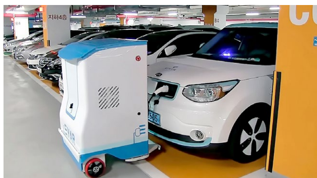
Рис. 11. Роботизированная мобильная зарядная станция EVAR от «Samsung». Заимствовано из: https://cdn.hevcars.com.ua/wp-content/uploads/2018/09/samsung-epar-hevcars-1.jpg .
