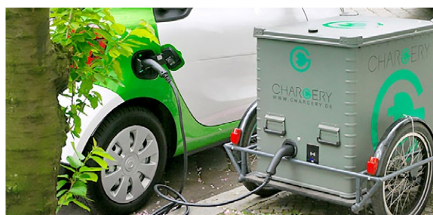
Рис. 7. Мобильная электростанция на базе велотрайка. Заимствовано из: https://a.d-cd.net/iP42d1BzyQy21Dnls6HcrMyq7ug-1920.jpg . 2019.
