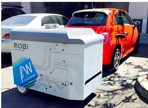
Рис. 10. Мобильная электростанция для общественных паркингов и стоянок. Заимствовано из: https://soymotor.com/sites/default/files/usuarios/redaccion/portal/javimartin/bp-free-wire-mobi-charger_3.jpg . © Producciones Audiovisuales SoyMotor, S.L. Copyright, 2018. Все права защищены.
