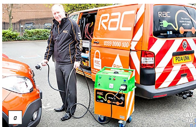
Рис. 5. Мобильные электростанции на базе малотоннажных фургонов: a — на базе фургона N1, b — на базе фургона M1. Заимствовано из https://images.forococheselectricos.com/image/l/1100w/wp-content/uploads/2014/05/Tim-Hartles-demonstrates-the-RACs-new-electric-charger-2-800x579.jpg © ZERauto.nl, 2014. Все права защищены. и http://https://www.pinterest.com/pin/angel-car-worlds-first-mobile-charging-station-for-electric-cars--431923420493496566 .
