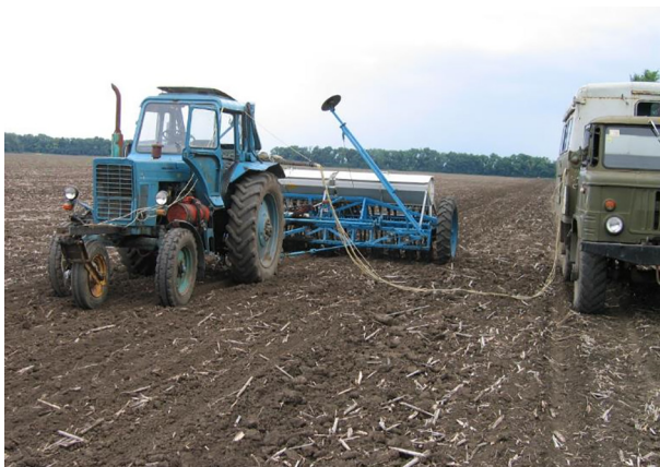
Рис. 3. Общий вид испытываемого трактора-макета в агрегате с прицепной сеялкой СЗ-5,4А и измерительным комплексом лаборатории ТЛ-2 на базе автомобиля ГАЗ-66
