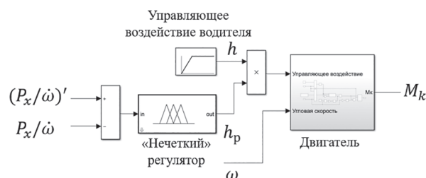
Рис. 16. Схема корректировки управляющего воздействия, задаваемого водителем, «нечетким» регулятором по P_x / \dot{\omega}
