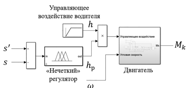
Рис. 6. Схема корректировки управляющего воздействия, задаваемого водителем, «нечетким» регулятором по s
