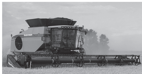
Рис. 1. Роторный зерноуборочный комбайн компании Gleaner
