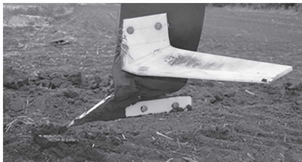
Рис. 4. Самоочищение элементов из пластика рабочего органа
