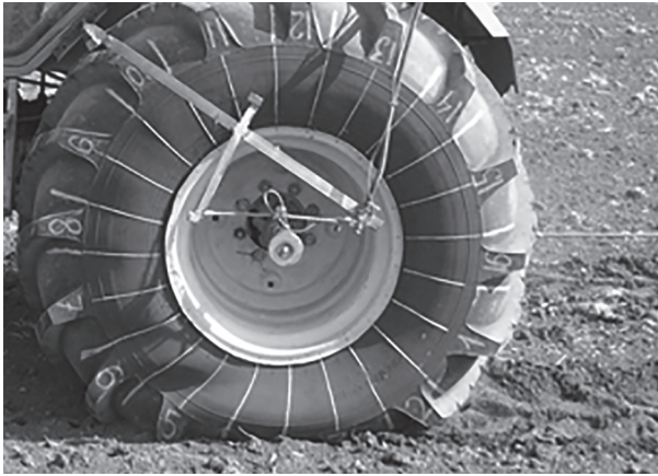
Рис. 5. Деформация шины ведущего колеса трактора при движении с предельной по уровню буксования тяговой нагрузкой
