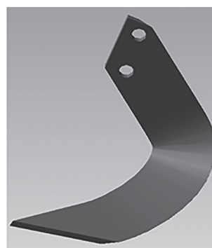
Рис. 2. Модель винтового ножа в трехмерном пространстве
