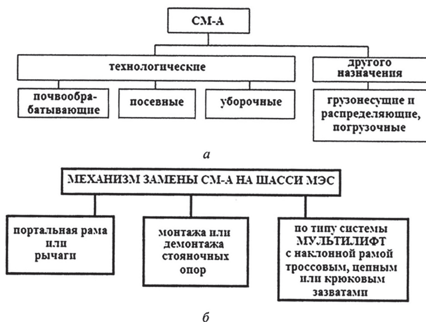
Рис. 4. Виды СМ-А (а) и механизмов их замены на шасси МЭС (б)
