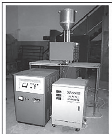
СВЧ-установка "МАГРА-Э" ("Магратеп", Фрязино) Производительность - до 400 кг/ч; Установленная мощность - 6 кВт
