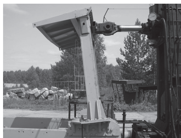
Рис. 4. Продольное нагружение ROPS
