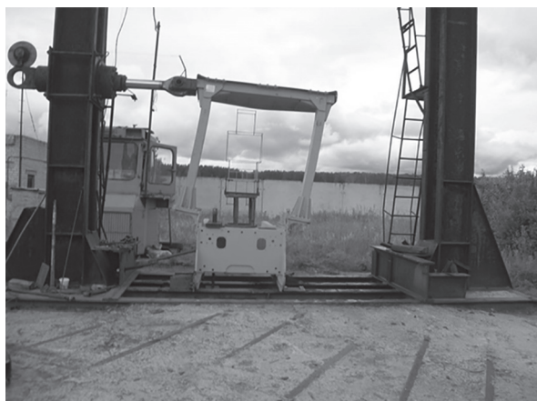
Рис. 2. Боковое нагружение ROPS
