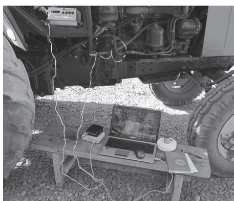
Рис. 1. Схема измерительно-вычислительного комплекса
