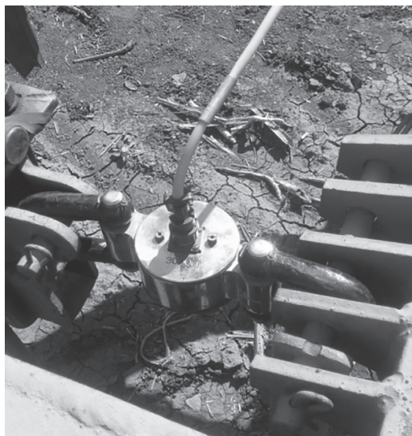
Рис. 3. Блок-схема измерительного комплекса и тензометрическое звено:
