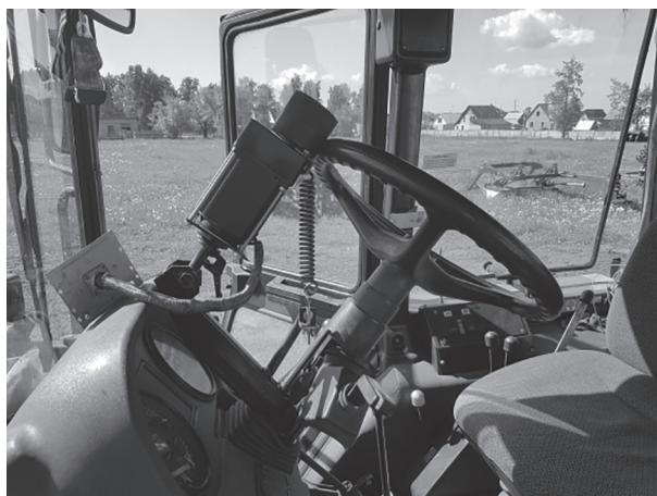
**Рис. 2. Крепление управляющего электродвигателя к рулевому колесу**
