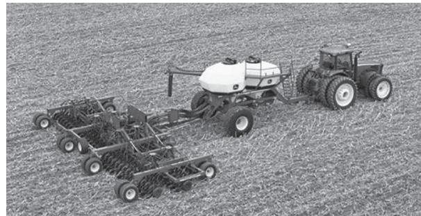
**Рис. 6. МТА с посевным комплексом
