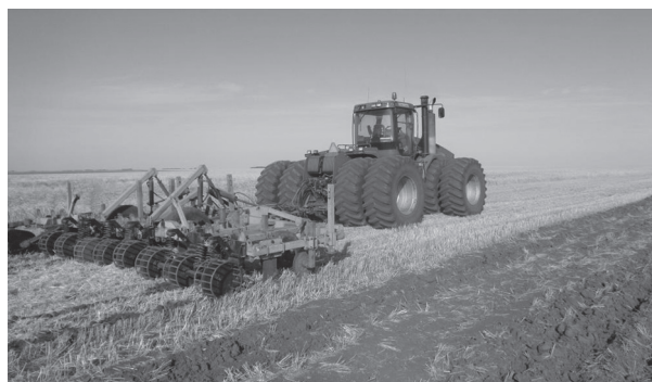
Рис. 4. Экспериментальный образец щелевателя для осенней обработки стерневых фонов: а – вид спереди сбоку; б – в агрегате с трактором Case 535, вид в работе
