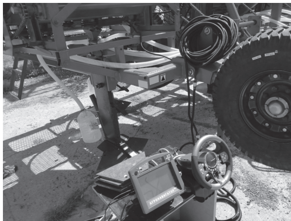
Рис. 2. Общий вид системы дифференцированного внесения минеральных удобрений с установленным симулятором
