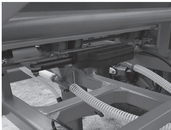
Рис. 3. Общий вид дозирующего устройства и актуатора
