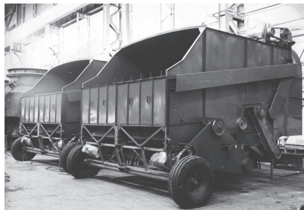
Рис. 1. Общий вид сепаратора измельченной хлебной массы
