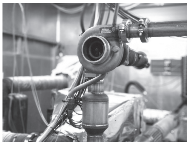
Рис. 7. Катализатор РТС с подачей вторичного топлива и турбокомпрессор
