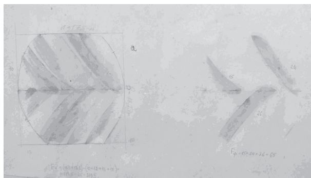
Рис. 2. Отпечатки площадей контакта тракторной шины 7,5L-16 с рисунком протектора «косая елка».
