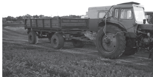
Рис. 1. Общий вид испытываемого трактора-макета в агрегате с транспортным прицепом ПТС-6 и измерительным комплексом лаборатории ТЛ-2 на базе автомобиля ГАЗ-66
