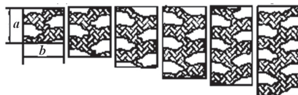
Рис. 3. Изменение размеров контакта колеса в зависимости от нормальной нагрузки
