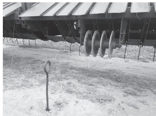
Рис. 3. Монтаж катушки с капроновой нитью на подбирающий аппарат
