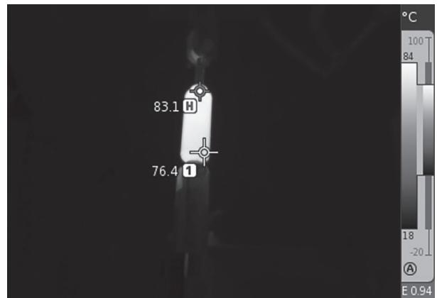
Рис. 3, в. Термограмма амортизатора в действии на 4-й минуте испытаний
