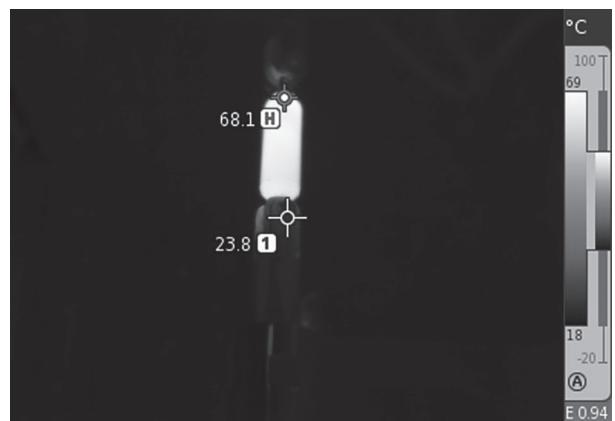
Рис. 3, б. Термограмма амортизатора в действии на 3-й минуте испытаний
