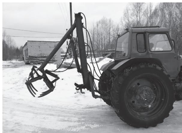
**Рис. 8. Фронтальный погрузчик прицеплен и навешен на сцепку трактора МТЗ**
