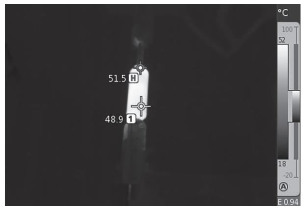
Рис. 3, а. Термограмма амортизатора в действии на 2-й минуте испытаний
