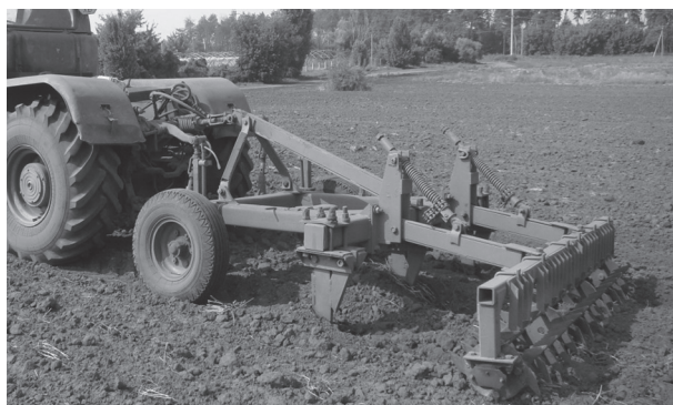
Рис. 2. Обработка почвы чизельным плугом с разным расстоянием между стойками
