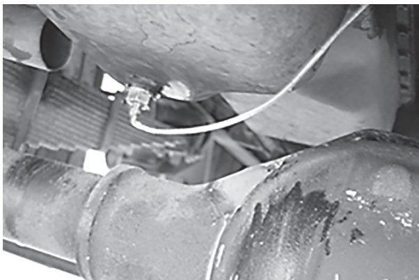
Рис. 1. Датчик температуры охлаждающей жидкости накладного типа, установленный на жидкостной коллектор
