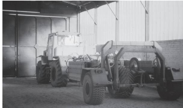
Рис. 1. Установка для оценки параметров шин и степени воздействия их на почву
