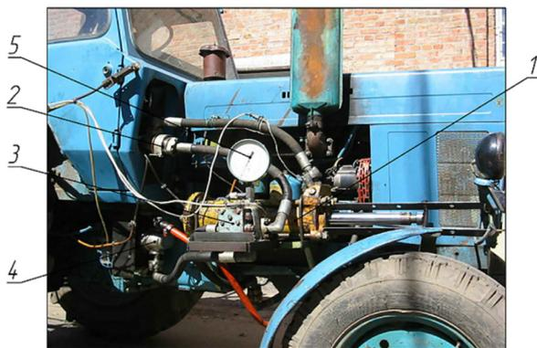
**Рис. 1. Общий вид компоновки элементов УДМ на тракторе:**
