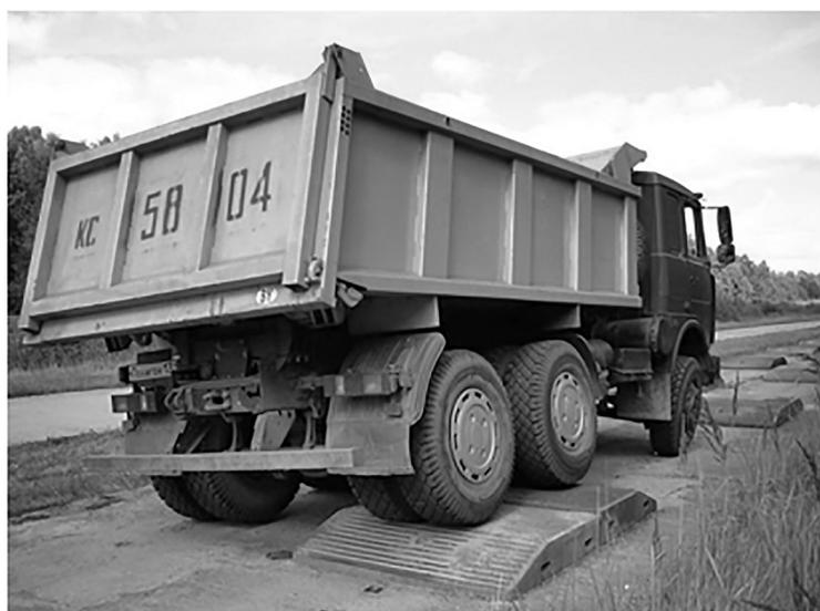
Рис. Моделирование эксплуатационного нагружения мобильной машины
