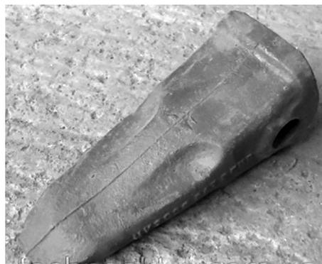
Рис. 1. Коронка зуба экскаватора фирмы Komatsu
