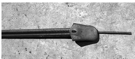
Рис. 5. Электрод из изношенной коронки погрузчика
