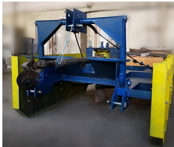
Рис. 1. Аппарат для срезания и измельчения кустов
