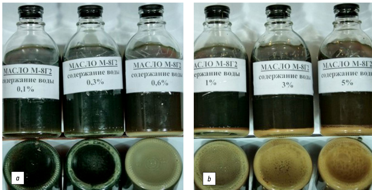
Рис. 2. Фотографии смесей водомасляных изменение смесей с зеркальным отражением свойства донной части емкостей: а) содержание воды 0,1%, 0,3%, 0,6%; б) содержание воды 1%, 3%, 5%.
