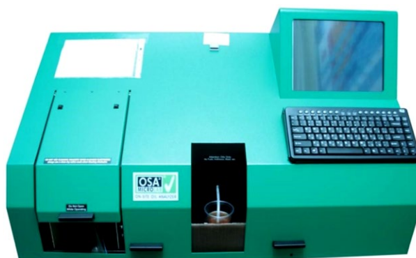
Рис. 1. Анализатор атомной эмиссионной спектроскопии OSA. Fig. 1. The OSA atomic emission spectroscopy analyzer.
