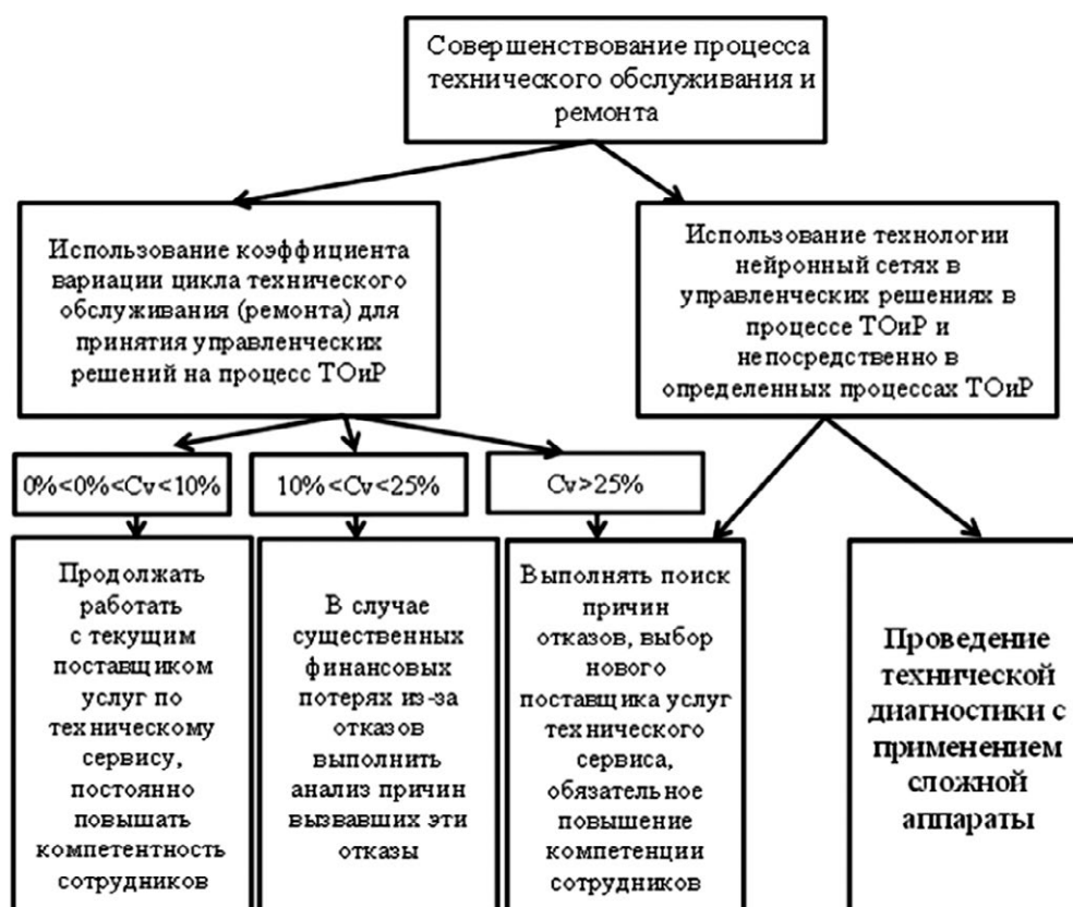
Рис. 5. Блок-схема механизма совершенствования процесса технического сервиса.
