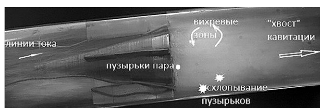
Рис. 5. Схема процесса кавитации. Fig. 5. Cavitation process diagram.
