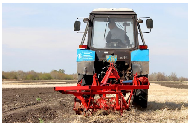
Рис. 2. Технологический процесс предпосевной обработки почвы с помощью макетного образца орудия, агрегируемого трактором МТЗ-82.
