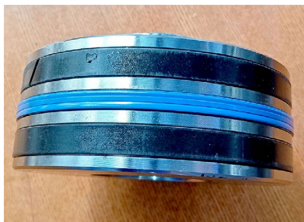
Рис. 10. Поршень гидроцилиндра вместе с уплотнениями. Fig. 10. A hydraulic cylinder piston together with seals.
